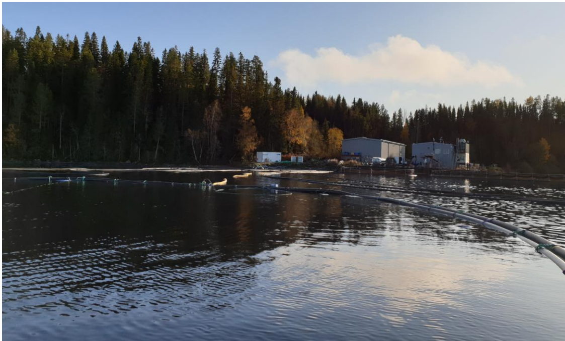
Bild 1. Avvattningsanläggningen syns i bakgrunden (vita containern) och de flytringar som syns närmast i bild visar delar av uppsamlingsenheten ram innan den sänks ner i vattnet.
