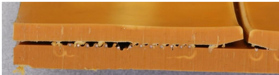
Figur 5. Tvärsnitt på elektrosvetsmuff 1 där ett område inte blivit sammansmält.
