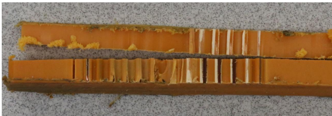
Figur 7. Skarv från elektrosvetsmuff 1
