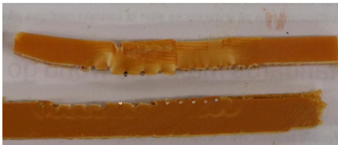
Figur 6. Skarv från elektrosvetsmuff 2.
