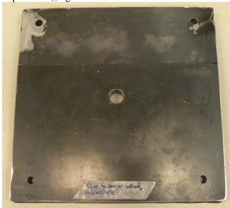
Figur 2. Bottenplatta för infästning av sadelgren i dragprovaren.
