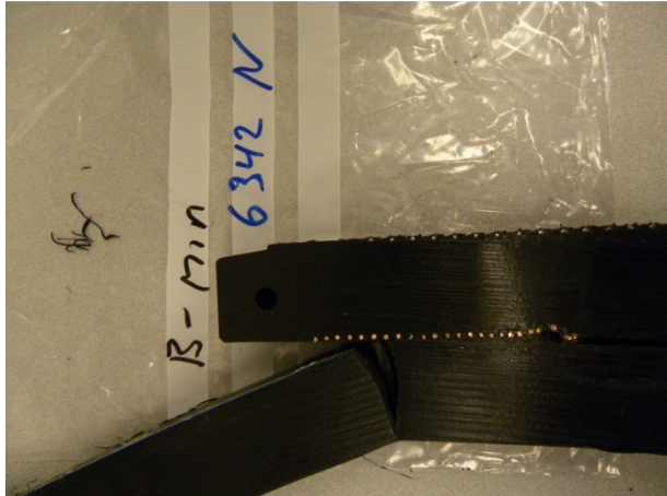
Figur 5 Brottyta Bmin. Brottet initierades i svetsen, i ett skikt som ligger något ovanför trådarna. Det fortsatte sedan in i röret.
