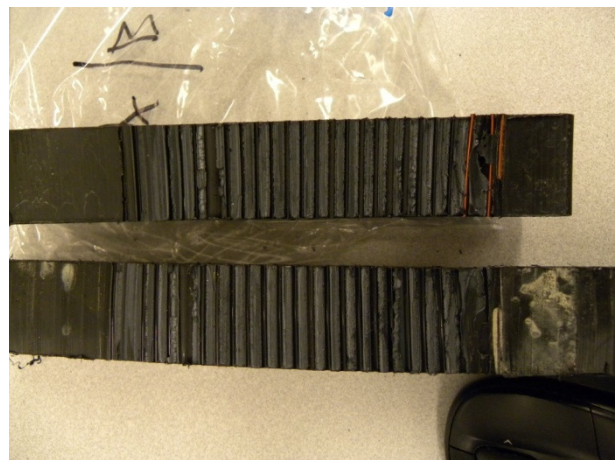
Figur 4 Brottyta A/B_{min} . Här skedde brottet i ytan med koppartrådarna.
