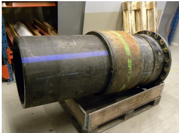
Figur 1 DN630 muff för testning av fläckhållfastheten.
